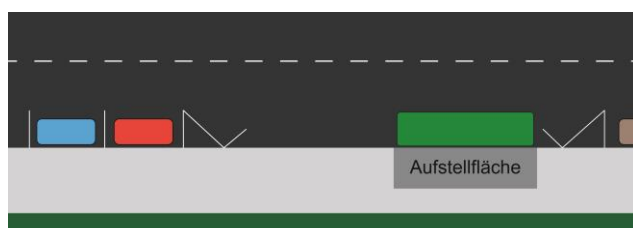
Abb. 2: Haltestelle am Fahrbahnrand mit Längsparkstreifen
